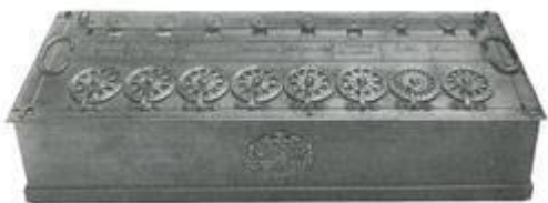
Machine comptable de Louis Périer : les deux roues de droite sont pour les livres et les deniers
